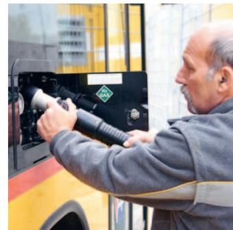
Ein Brennstoffzellenpostauto wird an der Tankstelle in Brugg mit Wasserstoff betankt.
