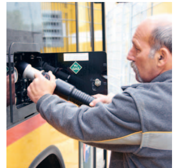
Un car postal à pile à combustible est ravitaillé en hydrogène à la station-service de Brugg.
