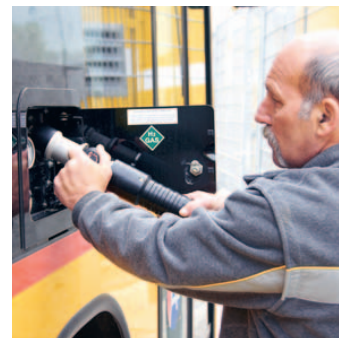
Un autopostale a celle combustibili viene rifornito di idrogeno alla stazione di servizio di Brugg.
